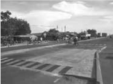
Dua bagian jalan yang ditinggikan dibuat bergetar di kedua sisi pulau tengah untuk memperlambat kendaraan sebelum mencapai zebra cross
